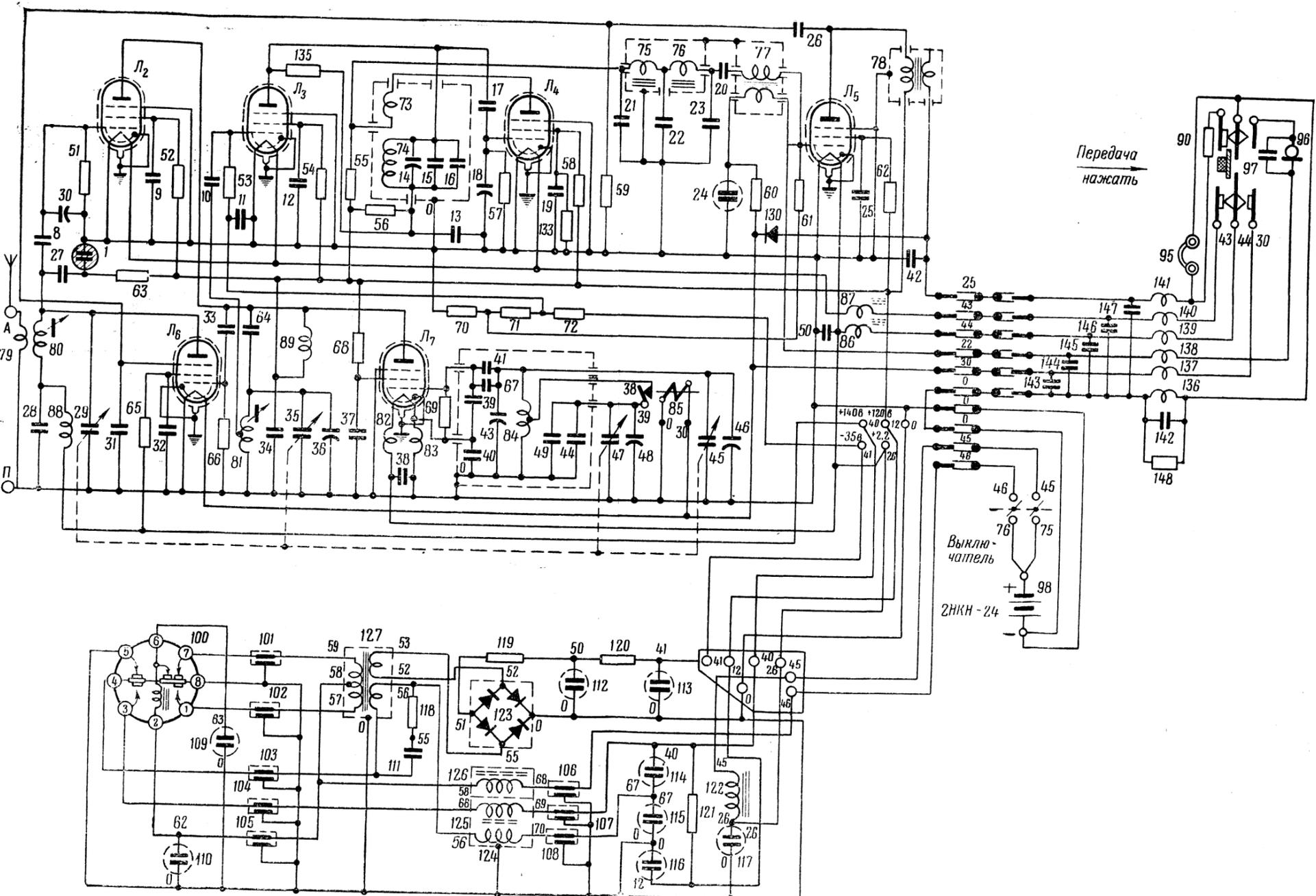
Рис. 16. Принципиальная схема радиостанции
