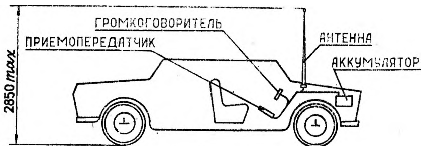
Рис. 5. Размещение радиостанции на автомобиле «ГАЗ-24».
