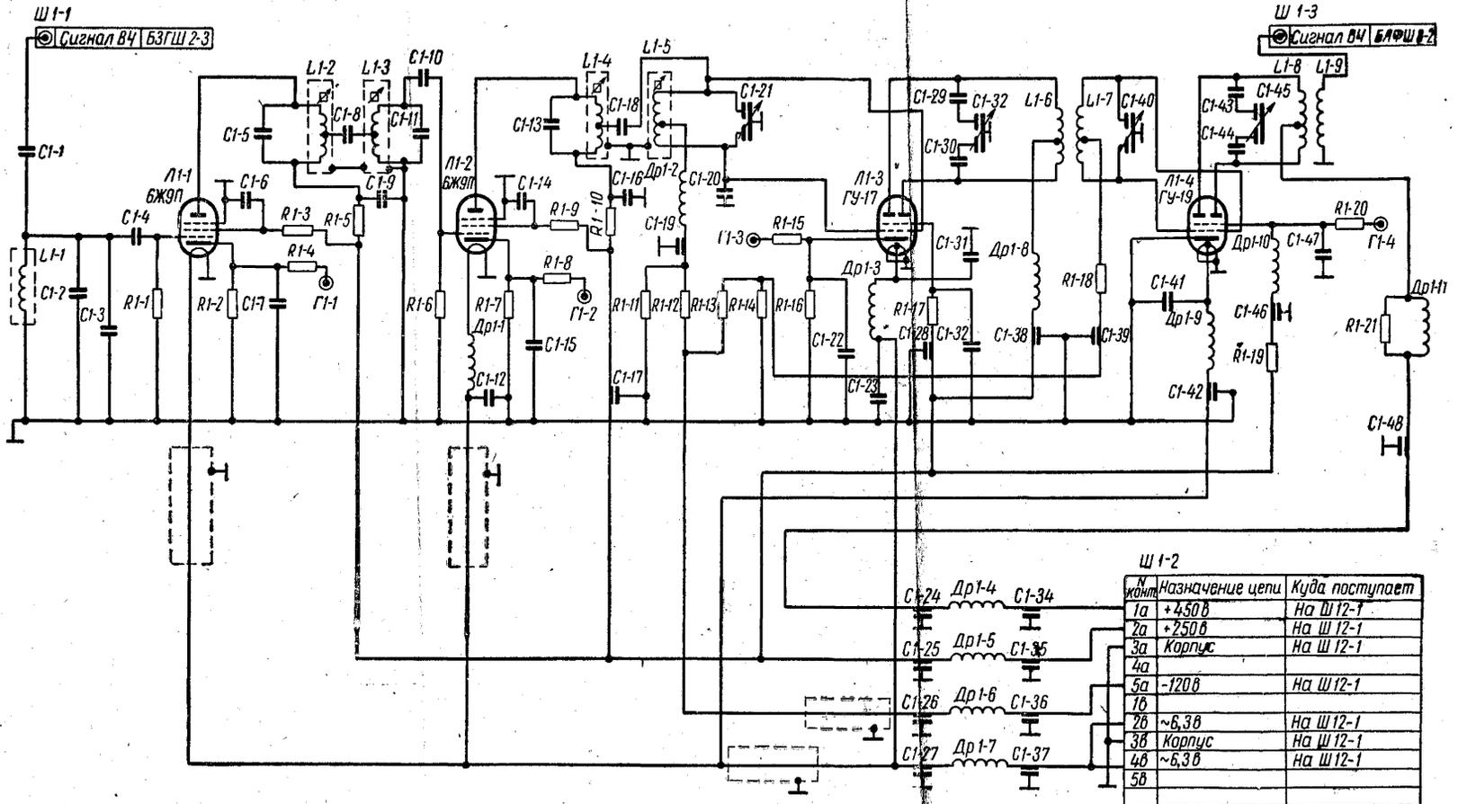
Принципиальная схема блока передатчика радиостанции „Порт-2“
