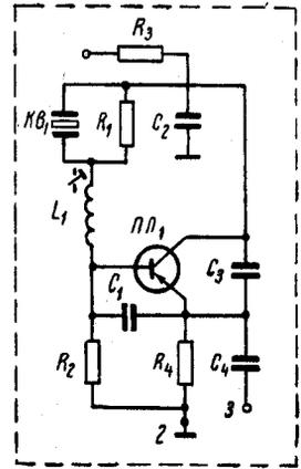
Принципиальная схема блока задающего генератора радиостанции „Порт-2“
