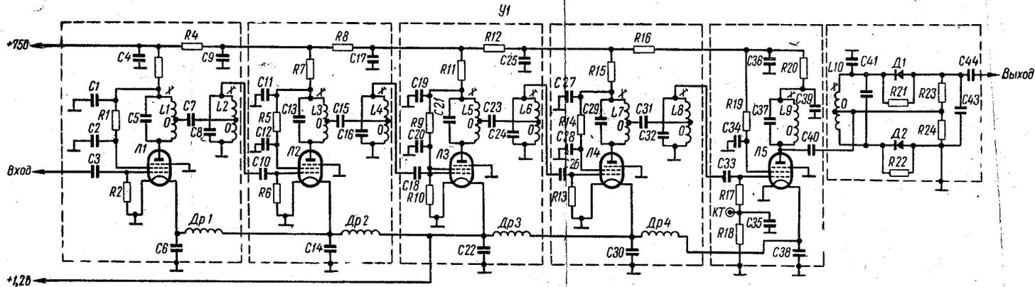
Принципиальная схема блока второй промежуточной частоты радиостанции „Лозман“
