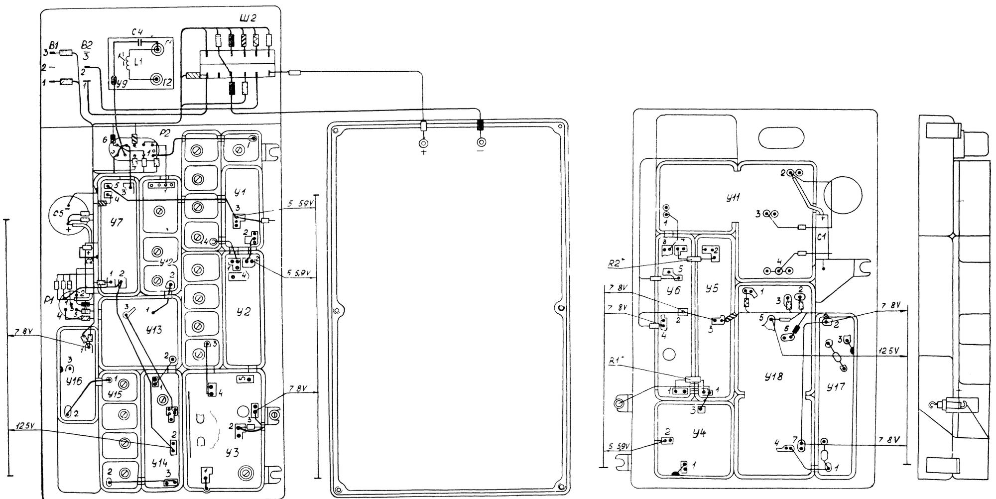
Рис. 5. Электромонтажный чертеж приемопередатчика.
