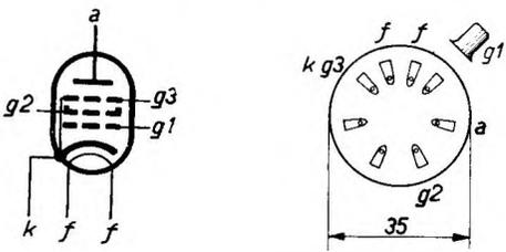
Elektrodenanordnung und Sockelschaltung.
