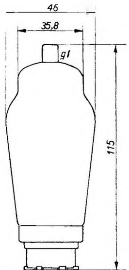
Abmessungen der Röhre AL2.
