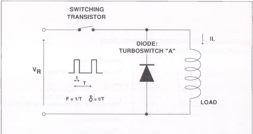
Fig. 2 : SNUBBER DIODE.
