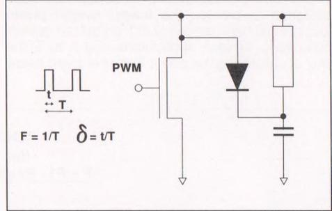
Fig. 4 : DEMAGNETIZING DIODE.
