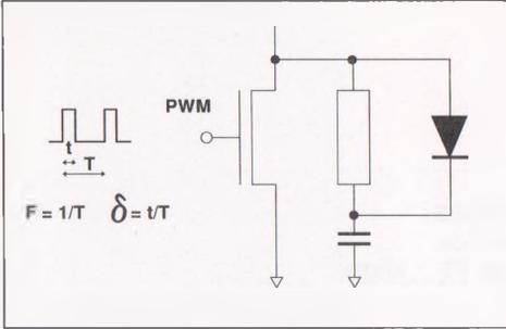
Fig. 3 : CLAMPING DIODE.
