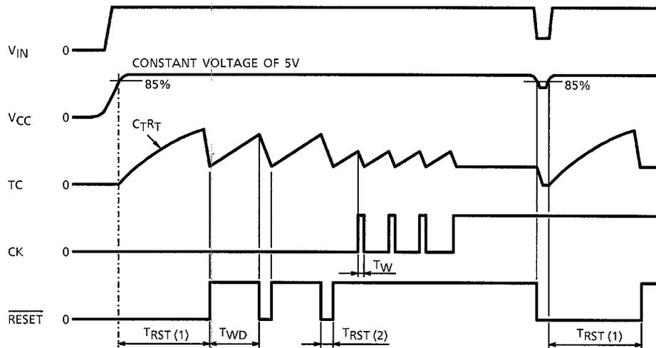
Note:  $T_{RST(1)}$ ,  $T_{RST(2)}$ ,  $T_{WD}$ ,  $T_W$  : See Electrical Characteristics.
