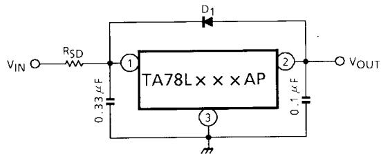
D<sub>1</sub> : IC protective diode
