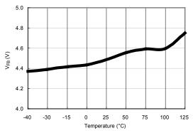
Figure 13. FB Open-Loop Voltage (VFB)
