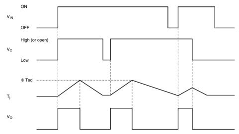
$Tsd:Overheat shut-down temperature (Tj \ge 110°C)$
