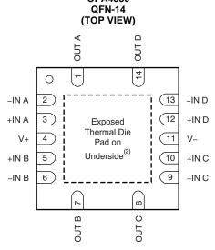
(2) Connect thermal die pad to V-.
