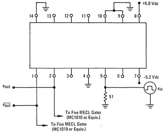
FIGURE 3 – COMMON-MODE INPUT VOLTAGE RANGE
