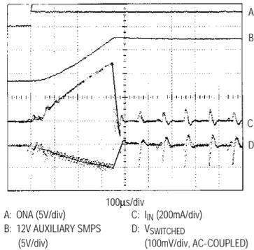
**START-UP WAVEFORMS (5V MAIN SMPS)**
