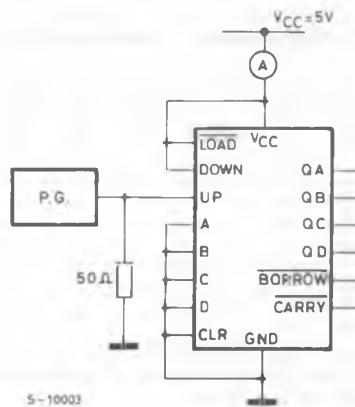
TRANSITION TIME OF INPUT WAVEFORMS IS THE SAME AS THAT IN CASE OF SWITCHING CHARACTERISTICS TEST
