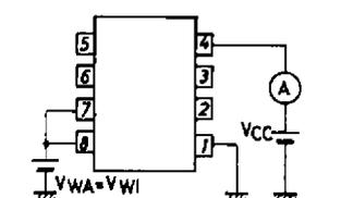
Test Circuit 12 :  $I_{CC2 OFF}$
