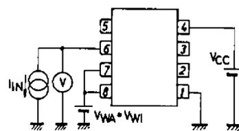
Test Circuit 6 :  $V_{IH4}$
