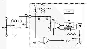
Figure 17. Pulse-Width-Modulation (PWM) Circuit
