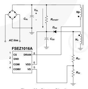
Figure 28. Startup Circuit
