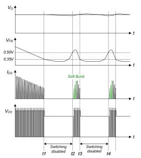
Figure 23. Figure 23. Burst-Mode Operation
