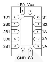
Figure 3. Pad Assignment DQFN-14 (Top View)
