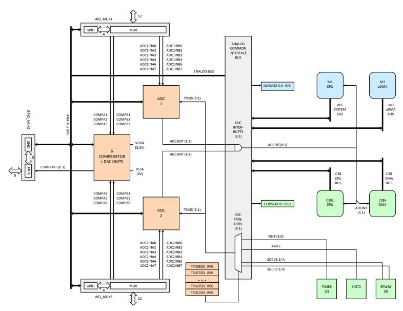
Figure 2-3. Analog Subsystem
