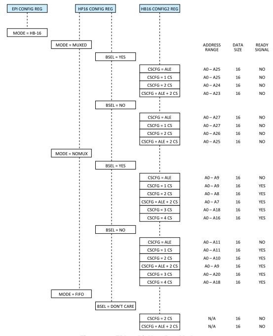
Figure 6-8. EPI 16-Bit Host Bus Mode
