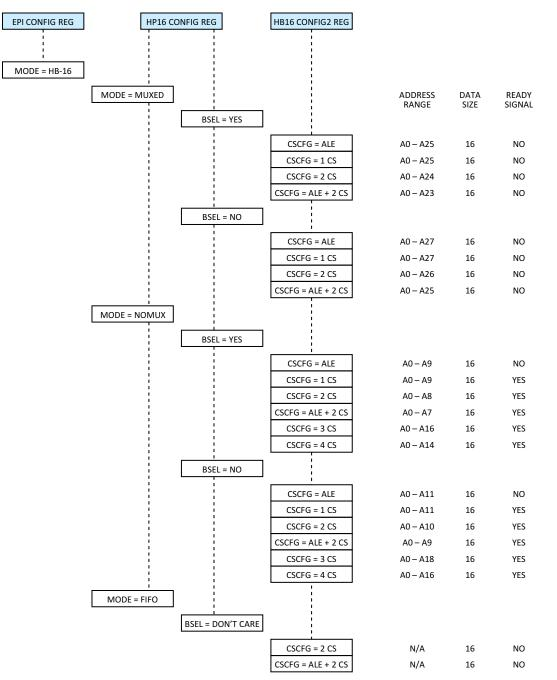
Figure 6-8. EPI 16-Bit Host Bus Mode
