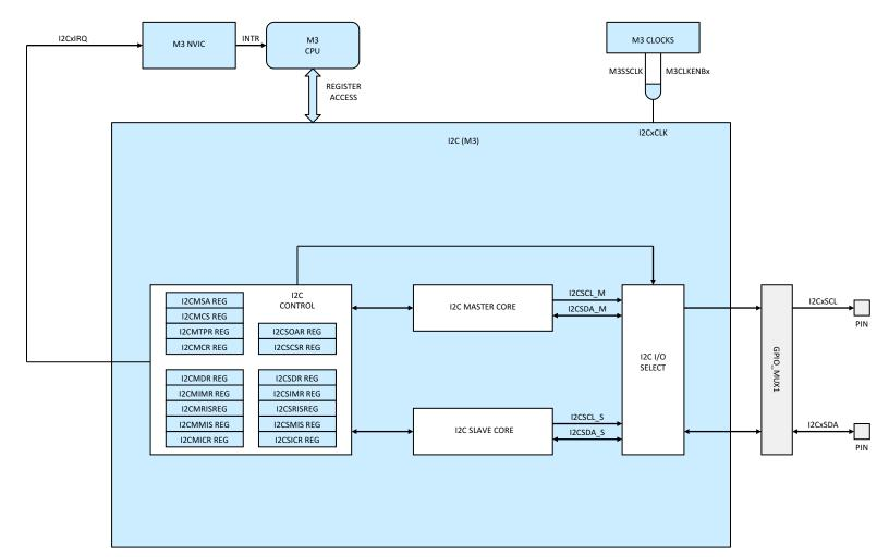
Figure 6-11. I2C (Cortex<sup>™</sup>-M3)
