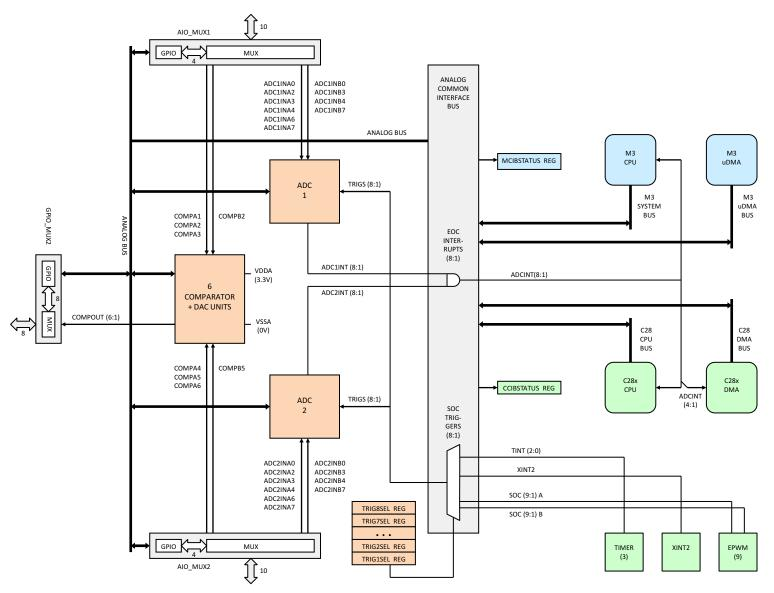
Figure 2-3. Analog Subsystem
