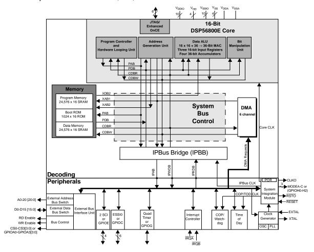
Figure 1. DSP56855 Block Diagram
