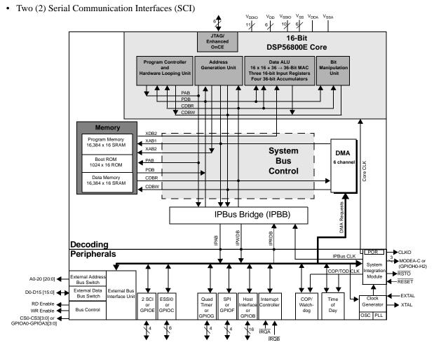
Figure 1. DSP56854 Block Diagram
