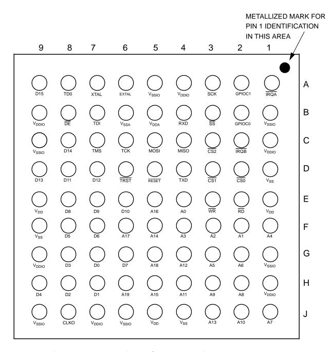
Figure 33. Bottom-View, DSP56852 81-pin MAPBGA Package
