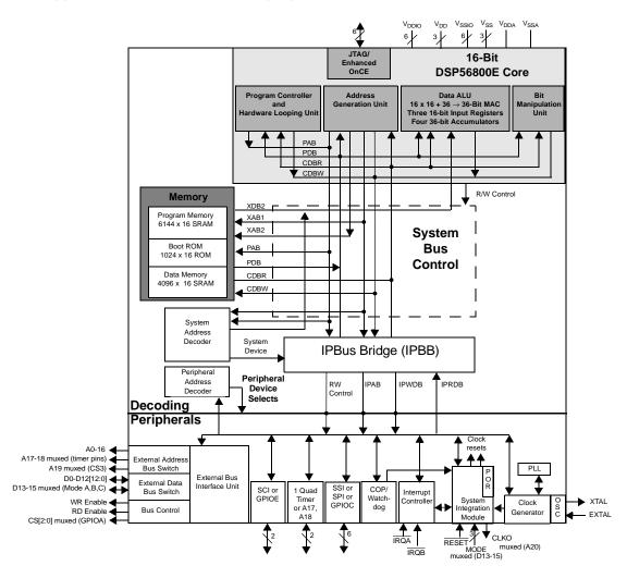
Figure 1. DSP56852 Block Diagram
