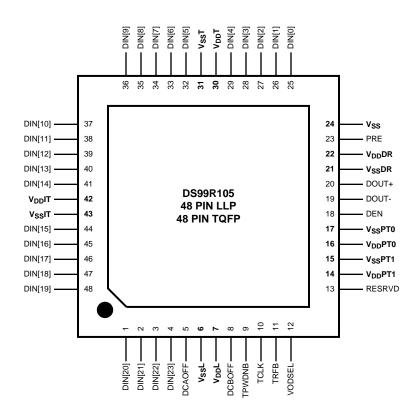
Figure 17. Serializer - DS99R105 - TOP VIEW
