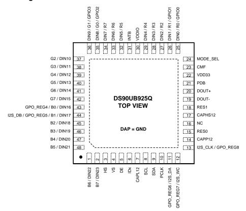
Figure 1. DS90UB925Q — Top View
