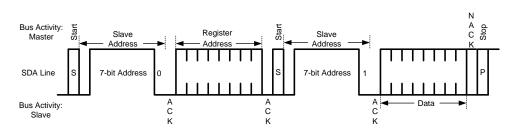
Figure 24. Write Byte
