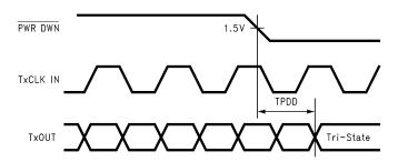
Figure 20. Transmitter Powerdown Delay
