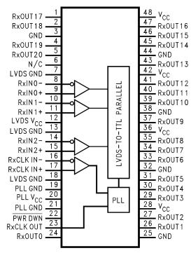
Figure 5. DS90CR562 - 48 Pin TSSOP See Package Number DGG
