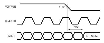
Figure 20. Transmitter Powerdown Delay
