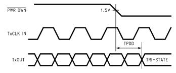
Figure 18. Transmitter Powerdown Delay
