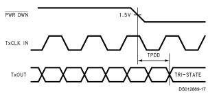
FIGURE 14. Transmitter Powerdown Delay
