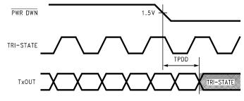
Figure 18. Transmitter Powerdown Delay
