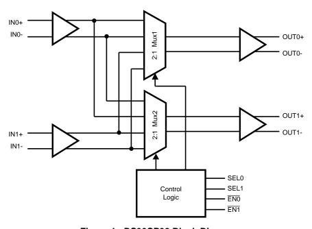
Figure 1. DS90CP02 Block Diagram
