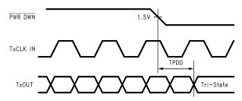
Figure 20. Transmitter Powerdown Delay
