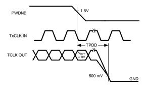
Figure 11. Transmitter Powerdown Delay
