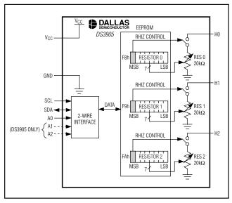
Figure 1. DS3904/DS3905 Block Diagram
