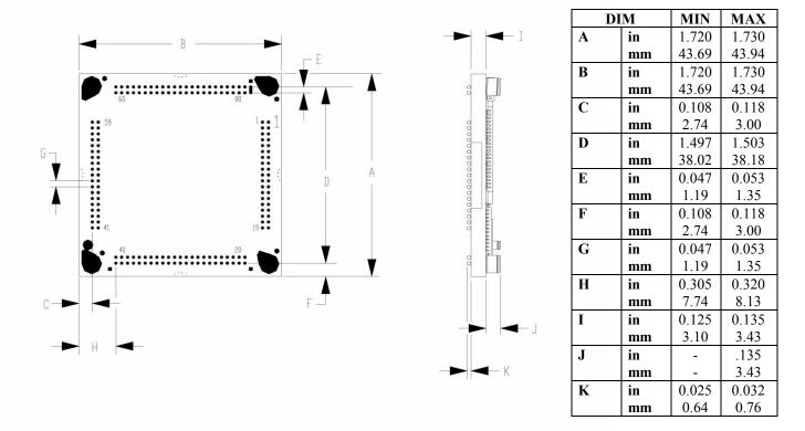
DS3832C-311 PACKAGE DIMENSIONS (With Attached DS3802 Battery Cap)
