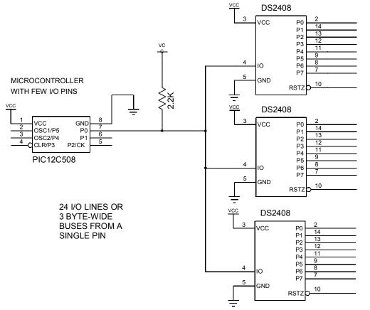
Figure 20. DS2408 AS μC-OPERATED KEYBOARD SCANNER
