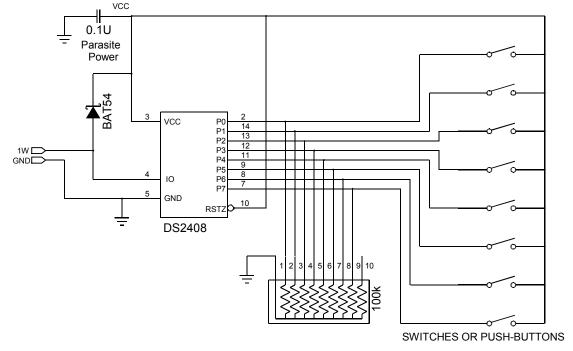
Figure 22. DS2408 AS MULTIPURPOSE SENSOR/ACTUATOR
