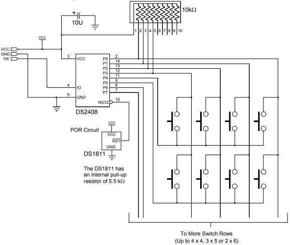
Figure 21. DS2408 AS PARASITE-POWERED PUSH-BUTTON SENSOR
