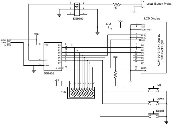
Figure 19. DS2408 AS MICROCONTROLLER PORT EXPANDER
