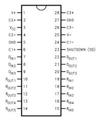
Figure 1. DS14C335 Top View See Package Number DB0028A
