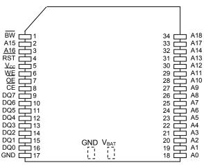
34-Pin PowerCap Module (PCM) (Uses DS9034PC PowerCap)
