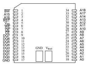
34-Pin PowerCap Module (PCM) (Uses DS9034PC PowerCap)
