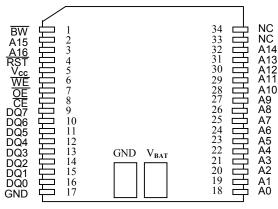
34-Pin PowerCap Module (PCM) (Uses DS9034PC PowerCap)
