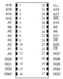
32-Pin ENCAPSULATED PACKAGE 740-mil EXTENDED
