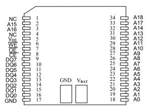
34-Pin POWERCAP MODULE (PCM) (USES DS9034PC POWERCAP)
