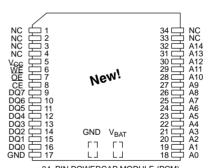
34-PIN POWERCAP MODULE (PCM) (USES DS9034PC POWERCAP)
