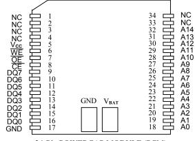
34-Pin POWERCAP MODULE (PCM) (USES DS9034PC POWERCAP)
