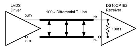
Figure 1. Typical LVDS Driver DC-Coupled Interface to an DS10CP152 Input
