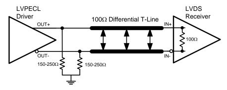
Figure 3. Typical LVPECL Driver DC-Coupled Interface to an DS10CP152 Input
