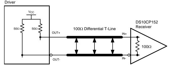
Figure 2. Typical CML Driver DC-Coupled Interface to an DS10CP152 Input
