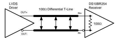
Figure 2. Typical LVDS Driver DC-Coupled Interface to an DS10BR254 Input
