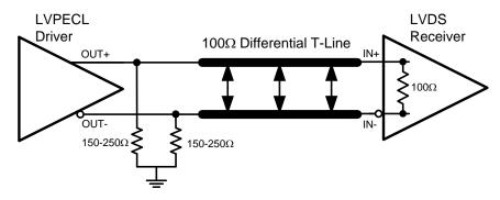
Figure 4. Typical LVPECL Driver DC-Coupled Interface to an DS10BR254 Input
