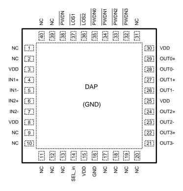
Figure 1. DS10BR254 Pin Diagram See Package Number RTA0040A
