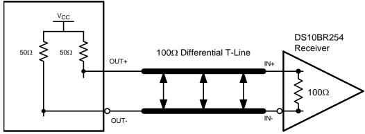
Figure 3. Typical CML Driver DC-Coupled Interface to an DS10BR254 Input
