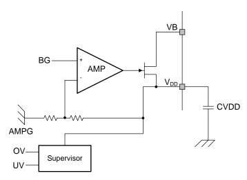
Figure 23. V<sub>DD</sub> Block Diagram
