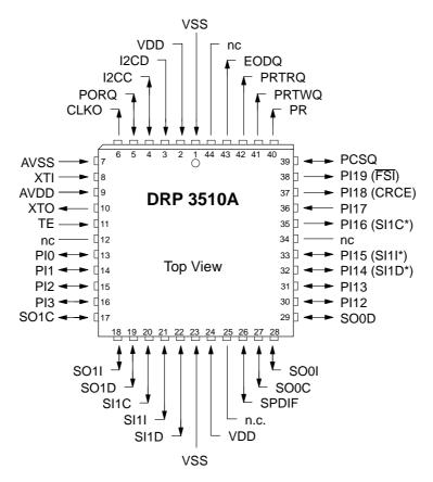
Fig. 3-2: 44-pin PLCC package
